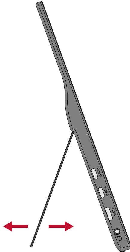
**NOTA:** Cuando realice el ajuste, sostenga el monitor firmemente con una mano mientras inclina el pedestal hacia atrás con la otra.
