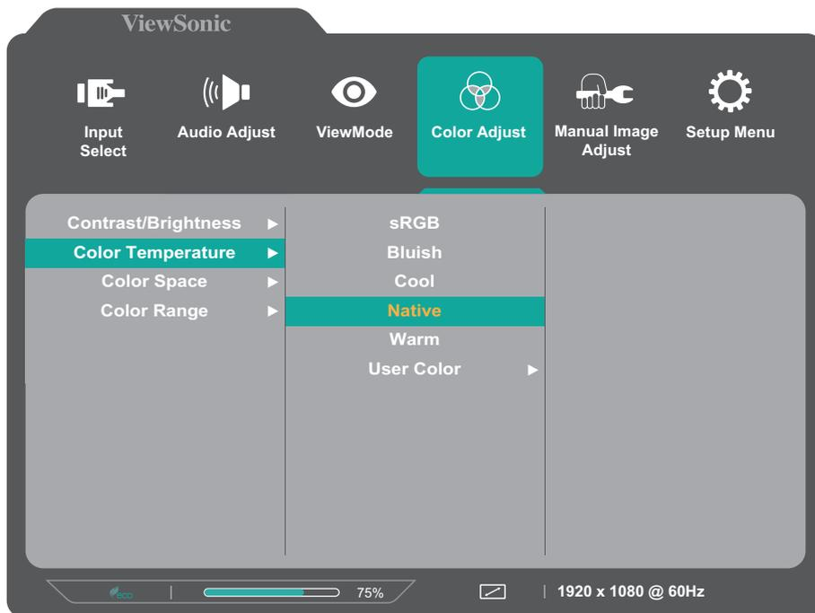
4. Presione el botón ▲ o ▼ para seleccionar la configuración. A continuación, presione el botón **Central (●)** para confirmar. O bien, presione el botón ◀ o ▶ para realizar los ajustes.
